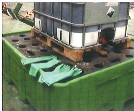
Cubeto de protección de productos químicos
