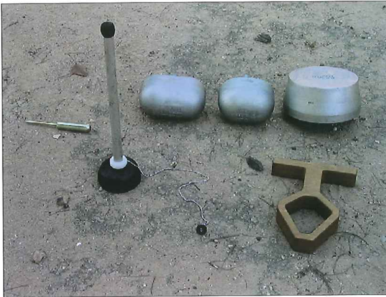
Equipo auxiliar (Sondas) de prueba para determinación de puntos de atrapamientos en los juegos. NORMA UNE-EN 1176. PARTE 1
