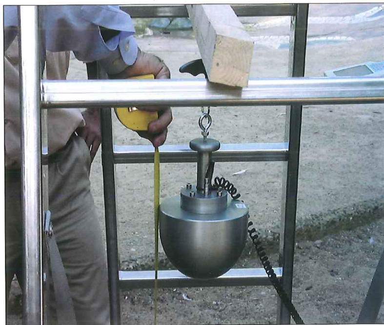
Ensayo para determinar la amortiguación del impacto de la superficie del área de juego. Equipo de medida. NORMA UNE-EN 1177
