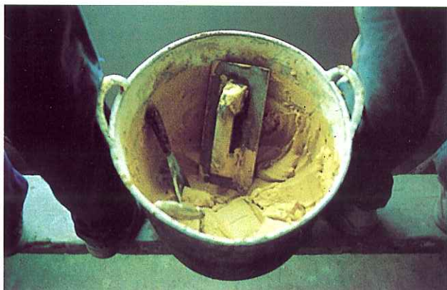
Recipiente (espuesta de goma) con mortero de estuco y algunas herramientas: llana, espátula y paleta.
