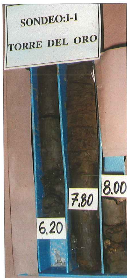
▲ Terreno de apoyo de la cimentación
