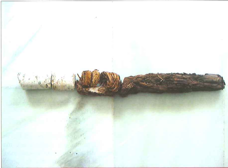
Muestra del rollizo de madera encontrado en la cimentación y terreno subyacente
