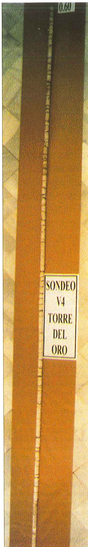
▲ Testigos de hormigón de cal desde la actual entrada a la base de la cimentación
