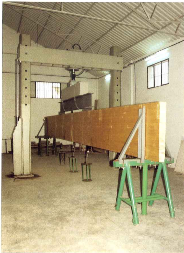
Ensayo a flexión de viga de madera laminada.
