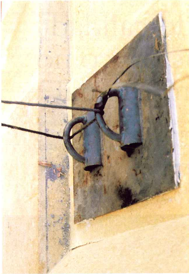
Ensayo de adherencia de aplacados sobre paramentos verticales.
