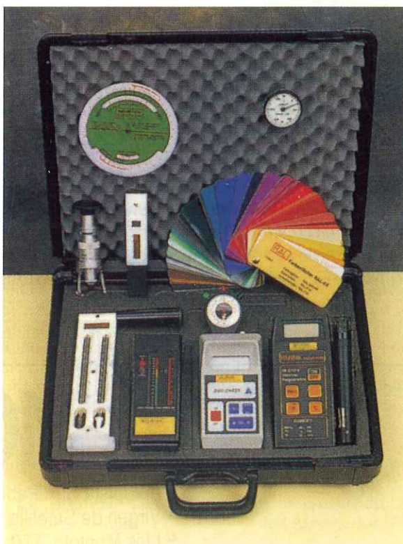
Malefín-test para construcción, modelo "Protimeter"
