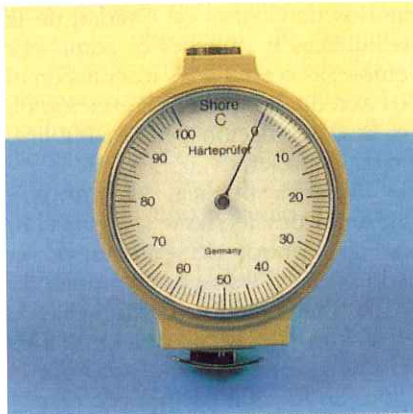
Medidor de dureza de yesos y escayolas.
