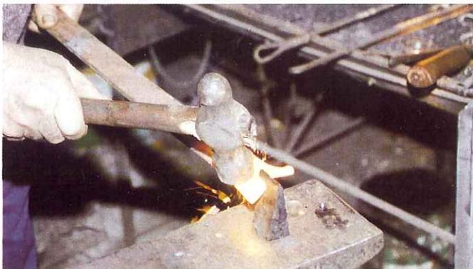
**Detalle de un hendido en una pletina de hierro durante el proceso de forja.**
