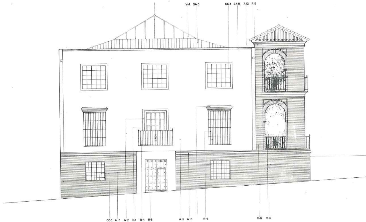
Fachada lateral (estado actual). Aparece el zócalo de ladrillo visto que no se ha ejecutado.
